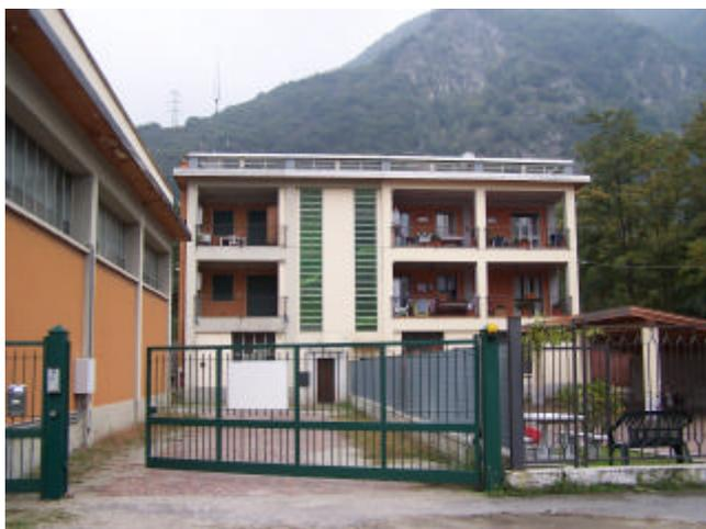
Le facciate sono costituite da specchiature in intonaco per esterni, i balconi sono in stecche metalliche verticali, i serramenti esterni sono in legno a battenti con vetri semplici e avvolgibili <sup>(6)</sup> e in serrande metalliche con vetri retinati <sup>(7)</sup>.
